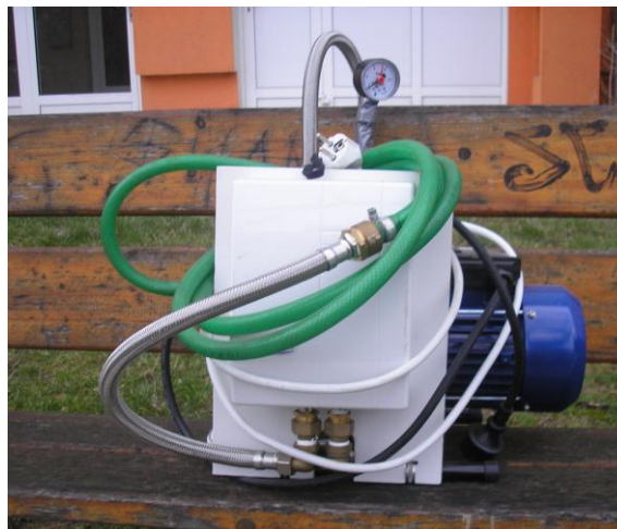
Obr. 5: Home made zařízení na TRT testy o tepelném výkonu 3 KW (cena 20 000 Kč i s prací), měřicí ústředna s GSM přenosem má rozměr 20 × 30 × 8 cm.
