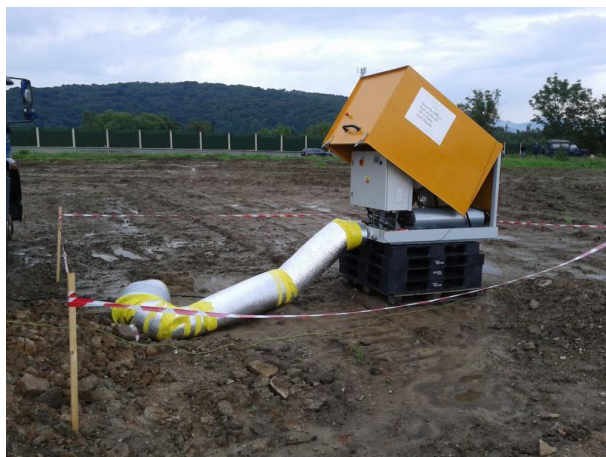
Obr. 4: Klasické zařízení na TRT testy o tepelném výkonu 5 KW.
